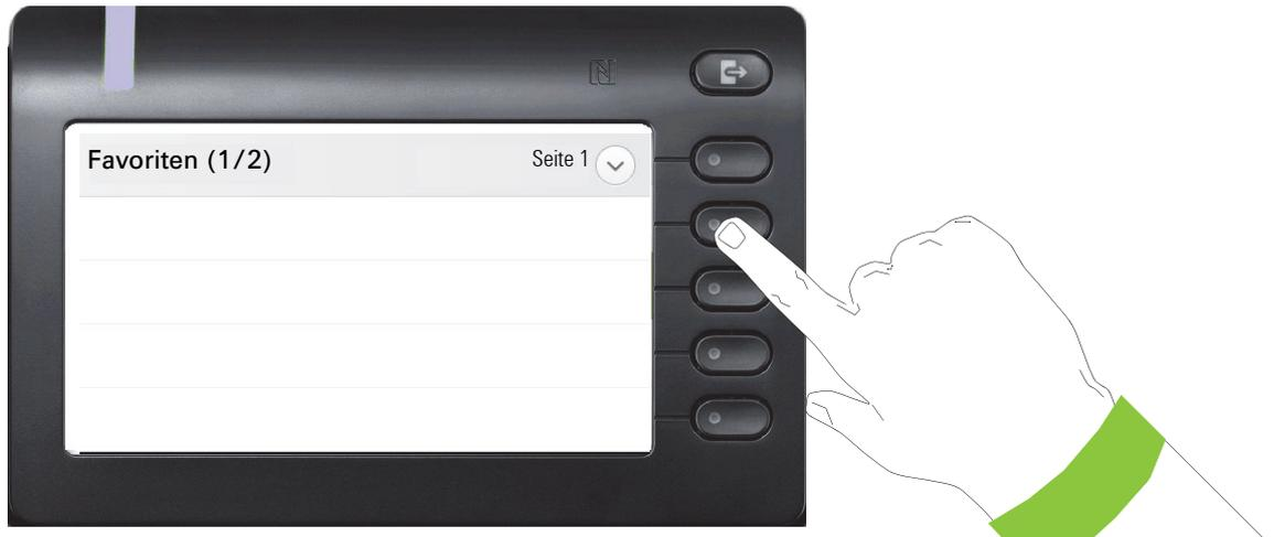
Drücken Sie den zweiten Softkey lange, um die erste von vier Funktionstasten auf Seite 1 zu belegen.
