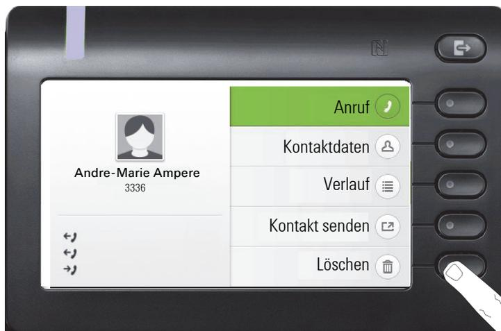
Drücken Sie den Softkey bei
