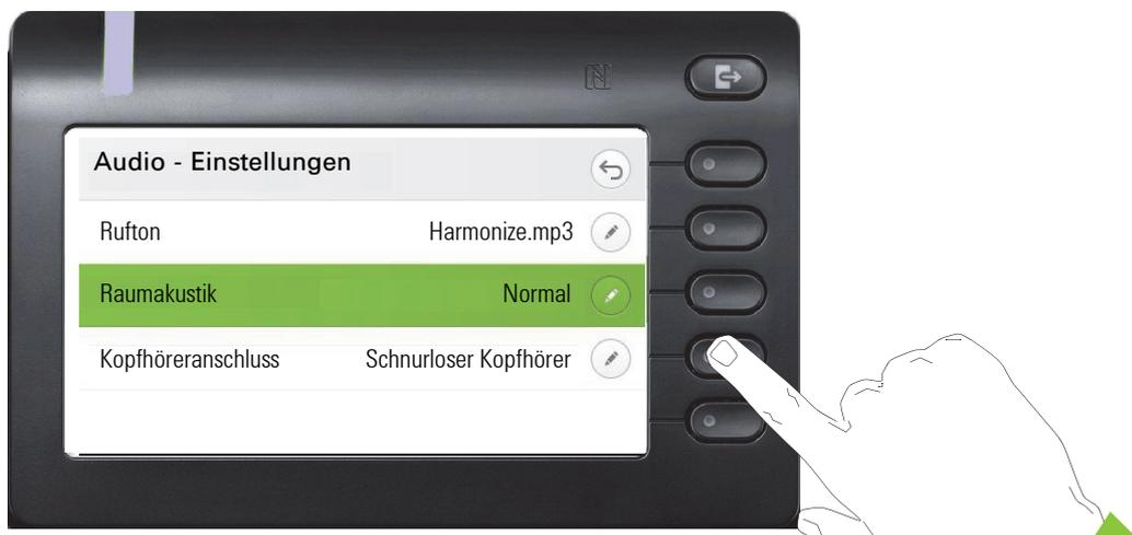
Drücken Sie den Softkey bei ✎ um die Einstellung zu öffnen.
