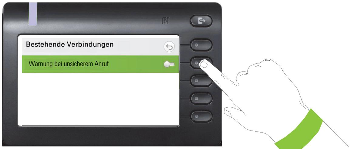
Auf den Softkey bei „Warnung bei unsicherem Anruf“ drücken, um die Funktion einzuschalten. Der Schalter wird nach rechts geschoben. Alternativ können Sie mit **OK** bestätigen, um den Schalter zu betätigen.
