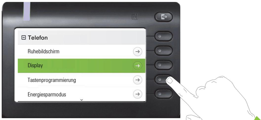
und öffnen Sie das Menü für Display mit dem Softkey.
