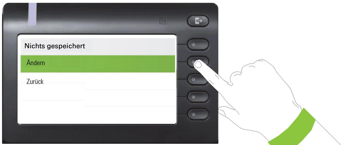
Wählen Sie mit der Taste
