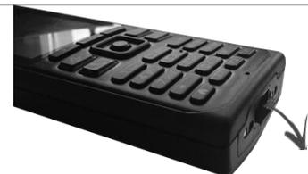
USB-Kabel den USB-Anschluss des Telefons anschließen. Das andere Ende des USB-Kabels am Netzteil oder einem USB-Anschluss anschließen.
